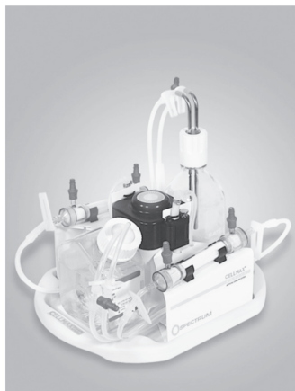
شکل ۱۰-۴: رآکتور هالوفایبر با پمپ و تانک محیط کشت. این مجموعه در داخل یک انکوباتور قرار می گیرد.
